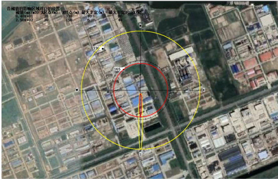
图 6.9.2-3 最不利气象条件乙腈超过阈值的最大轮廓线图
