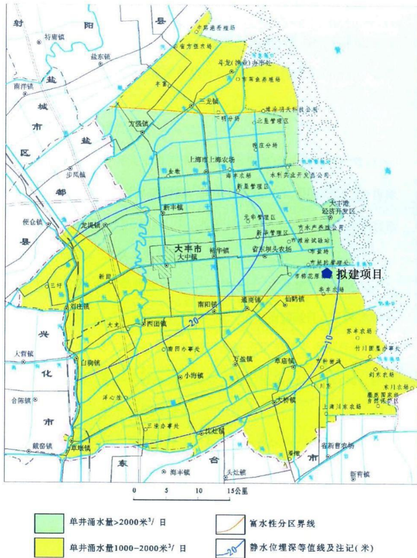
图 6.5.1-5 大丰区第IV承压含水层水文地质图（2010年）
