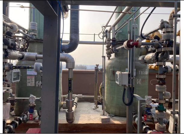
二级碱吸收（三氯吡氧乙酸、三氯吡氧乙酸丁氧基乙酯、350 罐区）
